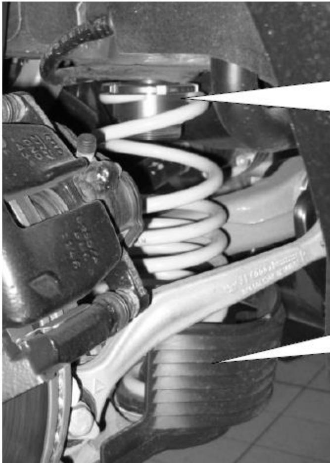
Die HA-Verstellung wird oben zwischen Feder und Karosserie montiert. Die serienmäßige Federunterlage entfällt. Zum Korrigieren (verdrehen des Gewinderings) der Fahrzeughöhe, ist die HA-Verstellung aus dem Fahrzeug zu demontieren.
