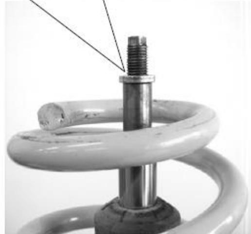
Das Original Domlager aufsetzen und mit der im Lieferumfang enthaltenen Mutter festschrauben. Das Anzugsdrehmoment der Kolbenstangenbefestigung beträgt 40 Nm. Die Montagehinweise zum Einbau des Federbeines in das Fahrzeug, sowie die Anzugsdrehmomente der Federbeinbefestigung, entnehmen Sie bitte den Unterlagen des Fahrzeugherstellers.
